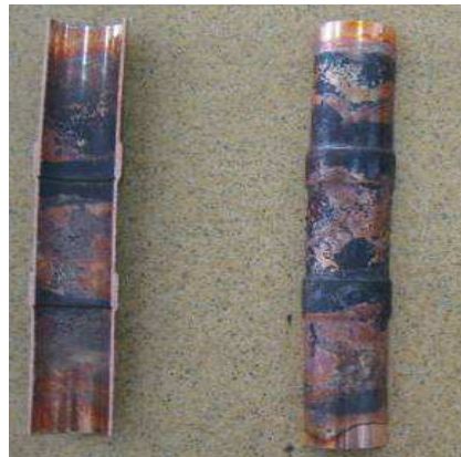
Foto 3: soldadura incorrectamente ejecutada sin circulación de Nitrógeno, generando oxidación.
