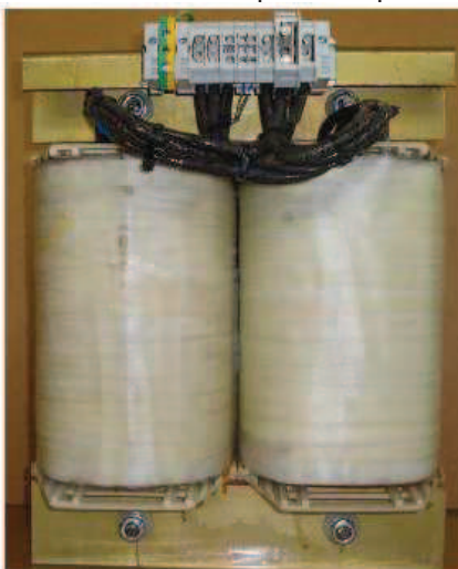
Fig. Transformador de aislación para red aislada.
