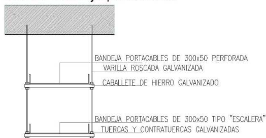
Detalle bandeja portacables
