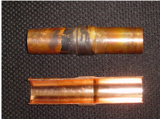
Foto 2: soldadura correctamente ejecutada con circulación de Nitrógeno, evitando oxidación.
