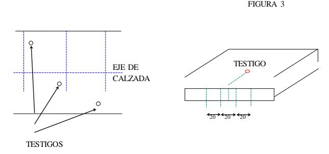
La determinación del espesor de un borde se efectuará sobre los puntos fijados en correspondencia con los testigos extraídos (Fig.2)
