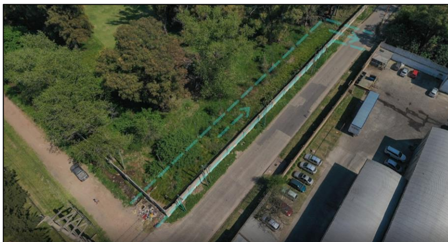
En esta recorrida se comprobó la existencia de un tramo de conducto existente de 2x2.60x1.40, ejecutado en 2013, en calle Drago entre Arenales y Yuca en cual se desarrolla dentro del predio de la Sociedad Alemana de Gimnasia debido a la fuerte presencia de interferencias sobre calle Drago.
