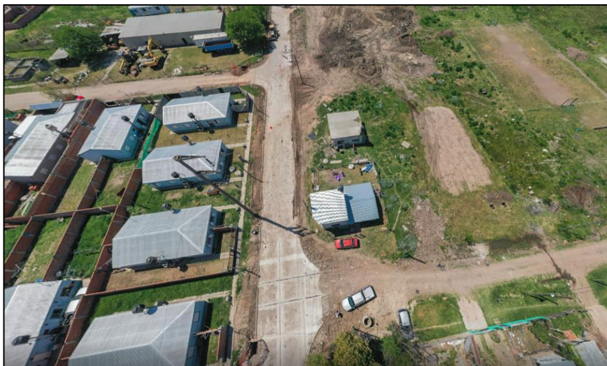
Ilustración 6 Ejecución de subramal 4-3-1 en calle Pino
